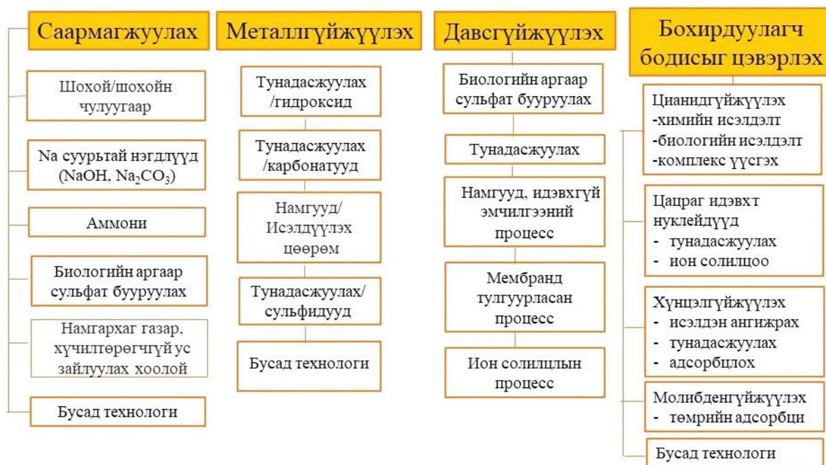
Зураг 9. Ус зайлуулах системийг цэвэрлэх технологи [32].
