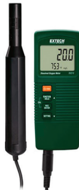
Ууссан хүчилтөрөгч, Хүчилтөрөгчийн ханалтын %, усны температур хэмжигч
